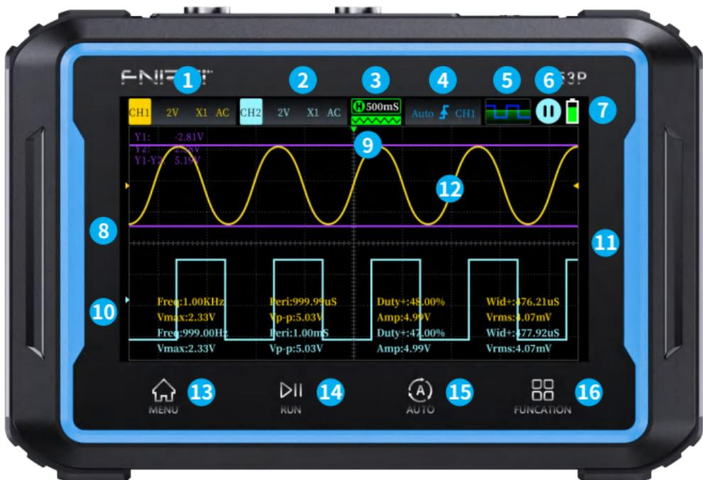
**①Definições do canal 1:** É possível definir o canal ligado/desligado, a tensão vertical, o rácio da sonda, o tipo de acoplamento e o limite da largura de banda de 20M.
