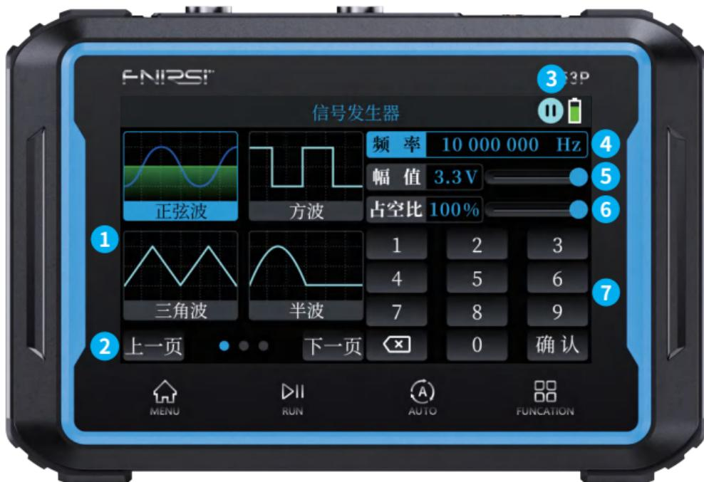
①**信号类型选择:**共有正弦波、矩形波、锯齿波、半波、全波、正阶梯波、反阶梯波、直流信号、指数升、指数降、多音频、辛克脉冲,12种波形。
