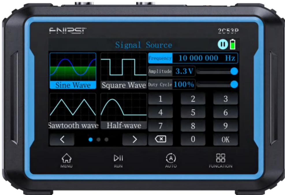
**① Выбор типа сигнала:** На выбор предлагается 12 типов сигналов, включая синусоидальную волну, прямоугольную волну, пилообразную волну, полуволну, полную волну, положительную ступенчатую волну, отрицательную ступенчатую волну, сигнал постоянного тока, экспоненциальный подъем, экспоненциальное падение, мультизвук и синхроимпульс.
